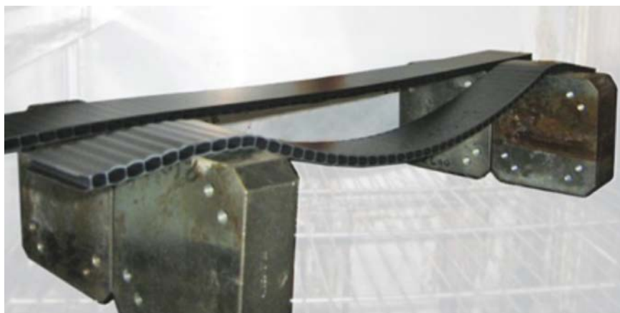
Bild 3. Die PPS-Stegdoppelplatte mit und ohne Tempern: Tempern garantiert eine stabile Stegdoppelplatten-Struktur (Probe hinten) im Gegensatz zu einer nicht getemperten Probe (vorne) bei 150 °C (© DS Smith Plastics)
