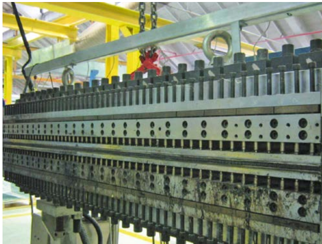
Bild 2. Das für die Extrusion von PPS geeignete Stegplattenwerkzeug
