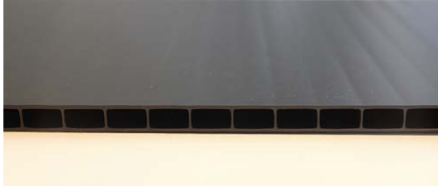
Bild 1. Querschnitt eines PPS-Absorbers
