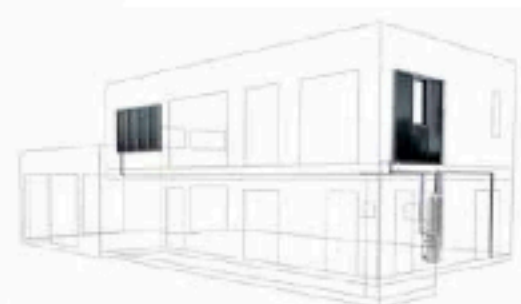
Solfangerne ligger integrert på to steder i fasaden.
