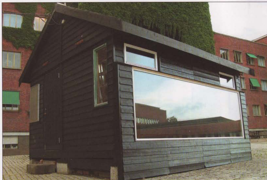
TEST. Nordans nye "vindu" med integrerte solfangere for oppvarming av varmtvann har blant annet vært testet ut i en paviljong utenfor Fysisk institutt ved Universitetet i Oslo.
